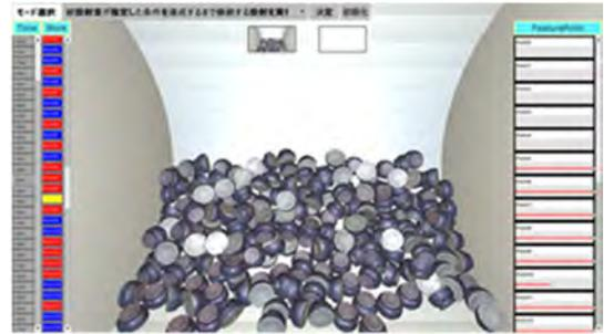
図4 ブラストマシンシミュレータの外観<sup>3)</sup>
